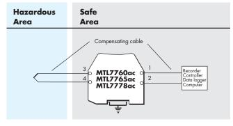
Figure A3: Thermocouple/mV input
